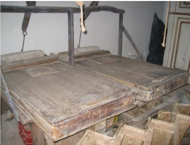
Los dos grandes fuelles en cuña de madera y piel, inservibles hoy pero que se pueden recuperar.
